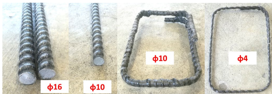
Fig. 2. BFRP rebars and stirrups
