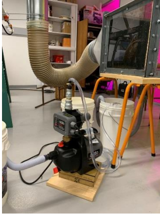
(d) Water pump and water tank
