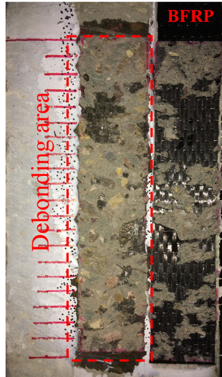
(d) Failure mode of (L) QS0-1 and (R) D0-8-1
