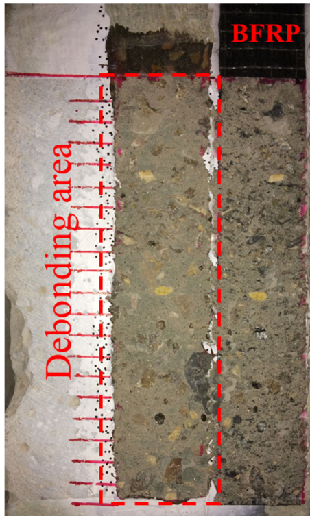
(d) Failure mode of (L) QS0-1 and (R) D0-8-1
